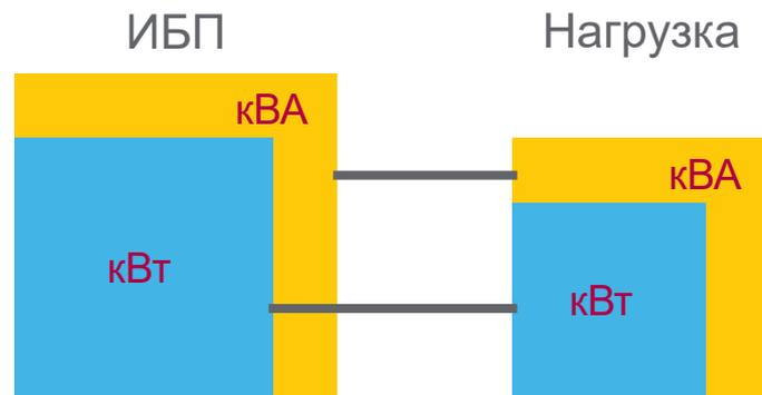
Мощность нагрузки в кВА и кВт должна быть меньше соответствующих значений мощности ИБП (с учетом стартовых токов нагрузки)
